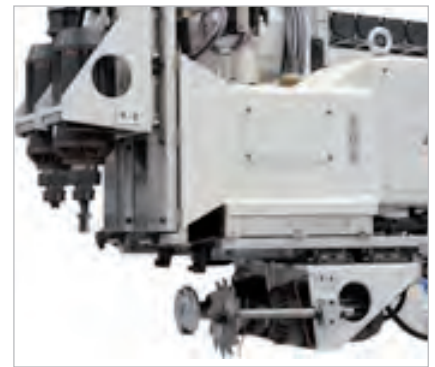
Unità operatrici indipendenti a 4 assi 18 kW e a 5 assi 12 kW, gruppo multifunzione con sistema brevettato di recupero listello e magazzini cambio utensile
