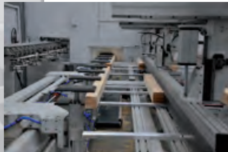
Prearico con controllo dimensionale dei grezzi Pre-loading phase with blank dimensions control
