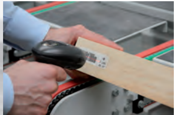
Letttore bar-code e selezione automatica dei programmi tramite lettura etichetta Bar code reader and automatic programme selection by label reading
