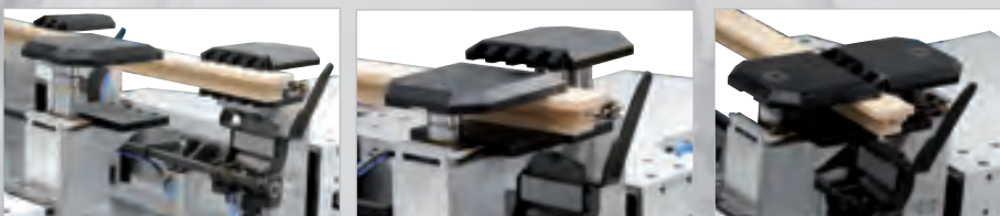
Sistema di bloccaggio e sequenza di cambio lato di presa Clamping system and sequence showing the change of the clamping side
